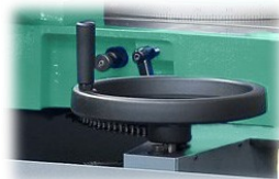
Handratt för vridning av sågbågen och arbetsbordet för gersågning
