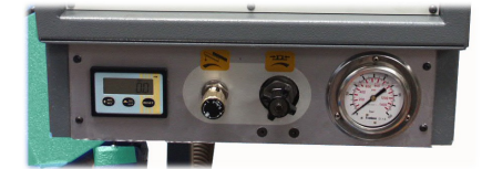
Digital visning av kapvinkel, justering av bågens sänkingshastighet samt justering av skruvstyckstryck
